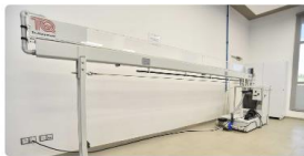
Banc de soufflerie pour l'étude en aérodynamique
